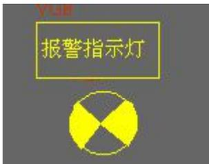
当设备出现故障时，红色报警蜂鸣器会报警。此时要检查水位、变频器、电源相位、和电机是否正常。排除故障后才能再次启动系统。当设备出现故障时，会在触摸屏上相应故障指示灯变色（如图 3 所示），具体内容有：
